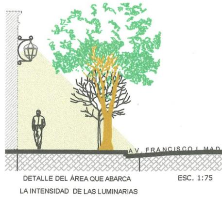
DETALLE DEL ÁREA QUE ABARCA LA INTENSIDAD DE LAS LUMINARIAS ESC. 1:75
