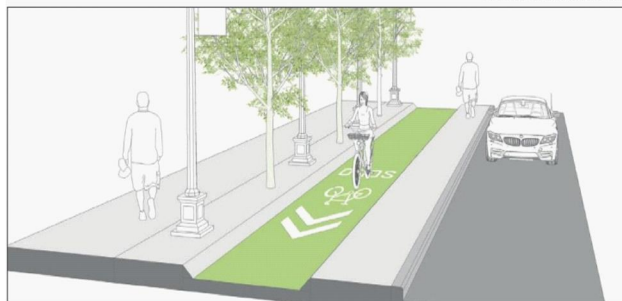
Ciclovia a nivel de calle
