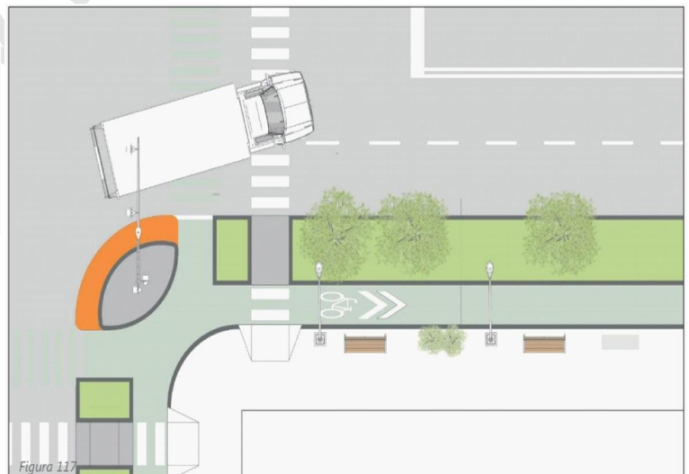
Figura 117. Línea de alto postergada Fuente: (Mass DOT, 2015)
