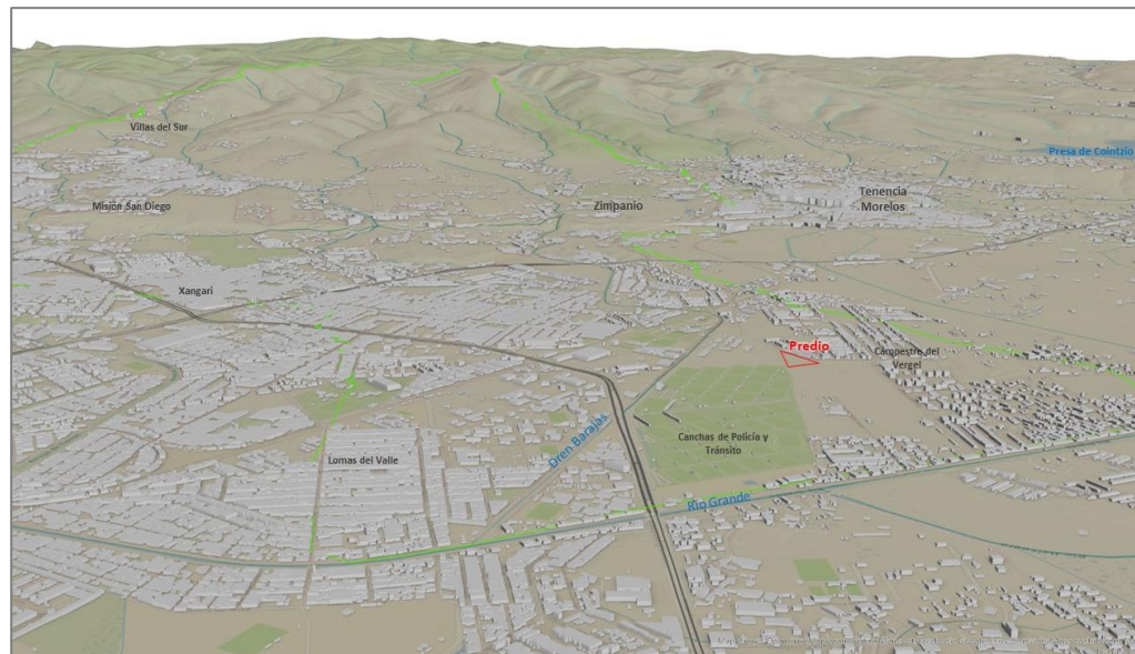
Figura. Modelación en 3D de la zona, permite observar los patrones de escurrimiento en la zona de aportación al predio. Fuente: Elaboración IMPLAN, 2025.
